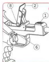
Položte palec na doraz záveru (1) a potiahnite páku záveru (2) Vašim ukázovákom a záver sa otvorí automaticky.
