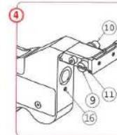
Skrutka č. 11 Točením v smere hodinových ručičiek sa rozšíri štrbina cieľnika, proti smeru hodinových ručičiek sa štrbina zúži.
